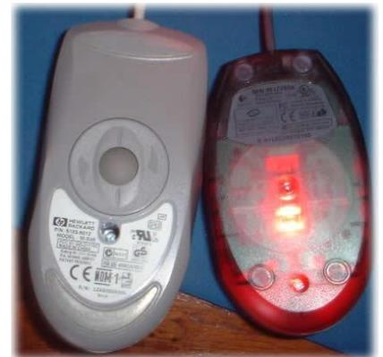
Les souris optiques fonctionnent sur les surfaces non parfaitement lisses ou bien possédant des dégradés de couleur. Les avantages principaux de ce type de dispositif de pointage par rapport aux souris mécaniques sont notamment une précision accrue ainsi qu'un encrassement moindre.
